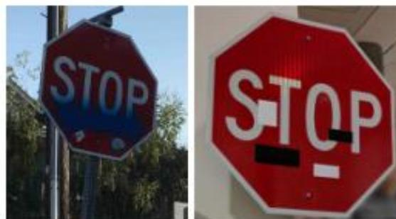
Abbildung 8: Manipuliertes Verkehrszeichen (Quelle: Eykholt et al., 2017: S. 2)
